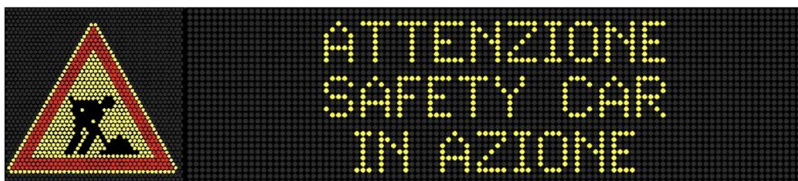
Fig. 5: Indicazione del presegnalamento del dispositivo safety car su pannello a messaggio variabile a tre righe di testo, riportante esempi di indicazione della potenziale situazione di pericolo presente sul tratto stradale.
