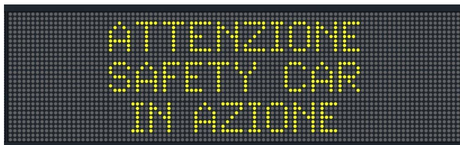
Fig. 3: Indicazione del presegnalamento del dispositivo safety car su pannello a messaggio variabile a tre righe di testo senza l'utilizzo di pittogrammi.
