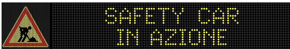
Fig. 4: Indicazione del presegnalamento del dispositivo safety car su pannello a messaggio variabile a due righe di testo, riportante esempi di indicazione della potenziale situazione di pericolo presente sul tratto stradale.
