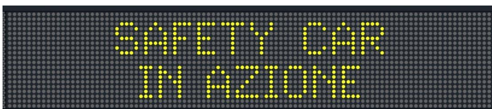
Fig. 2: Indicazione del presegnalamento del dispositivo safety car su pannello a messaggio variabile a due righe di testo senza l'utilizzo di pittogrammi.
