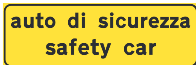
Fig. 1: Pannello segnaletico rettangolare di tipo fisso ad angoli arrotondati, realizzato con pellicola retroriflettente a elevata efficienza, di dimensioni non inferiori a 1,20 x 0,40 m, da utilizzare sui veicoli impiegati nell'esecuzione del dispositivo safety car.
