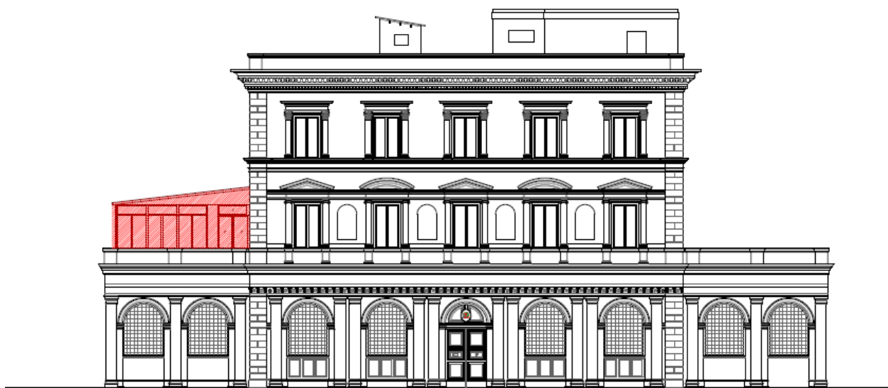
Prospetto nord con individuazione veranda priva di legittimità
