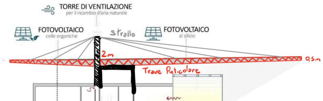
Figura 81. Possibile soluzione strallata per la copertura
