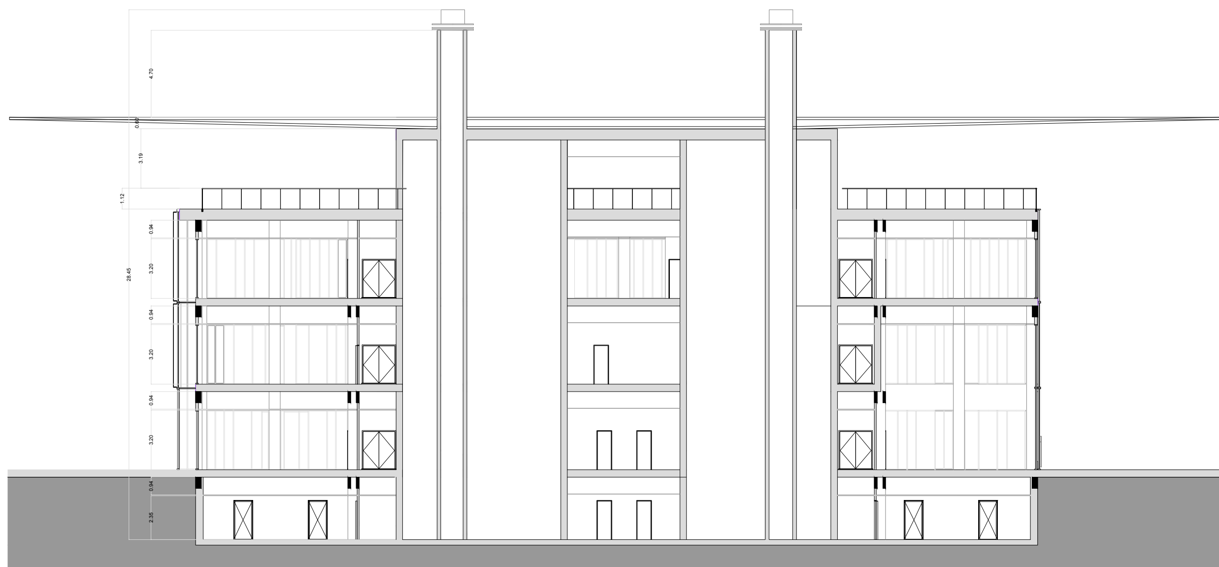
C-C' SEZIONE LONGITUDINALE Torri di ventilazione
